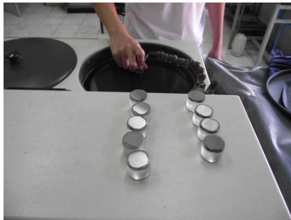
ภาพที่ 6 แสดงชิ้นงานเหล็กรั่วแบบดั้งเดิมในการสเปคโตรมิเตอร์ออปติค
