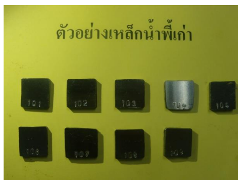
ภาพที่ 2 แสดงชิ้นงานเหล็กน้ำพี้ที่ได้จากเหล็กดั้งเดิม
