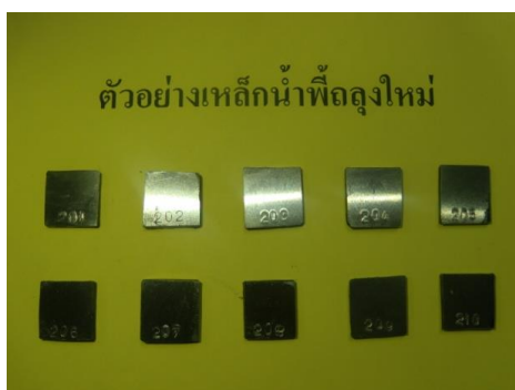
ภาพที่ 3 แสดงชิ้นงานเหล็กน้ำพี้ที่ได้จากการถลุงใหม่
