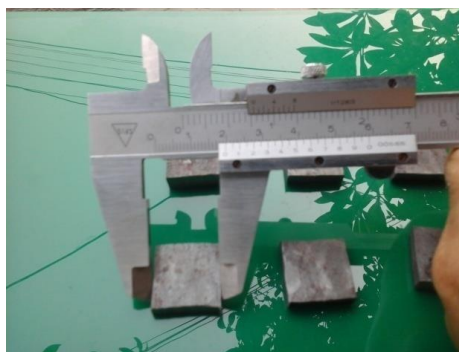
ภาพที่ 2 แสดงชิ้นงานเหล็กน้ำพี้ที่ได้จากเหล็กดั้งเดิม
