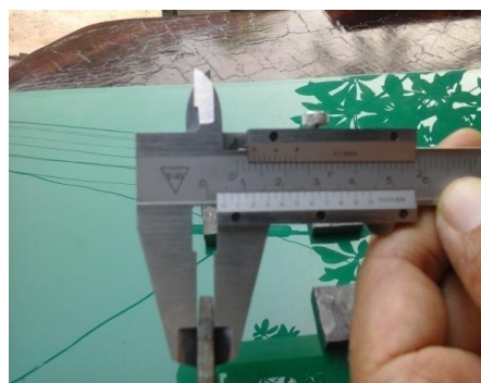
ภาพที่ 3 แสดงชิ้นงานเหล็กน้ำพี้ที่ได้จากการถลุงใหม่
