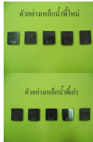
ภาพที่ 4 แสดงการเตรียมชิ้นงานเหล็กน้ำไฟที่ก่อนการทดสอบ
