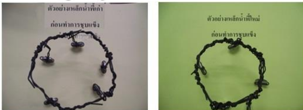
ภาพที่ 13 แสดงการเตรียมชิ้นงานทดสอบเหล็กน้ำพี้ กลุ่ม A และกลุ่ม C
