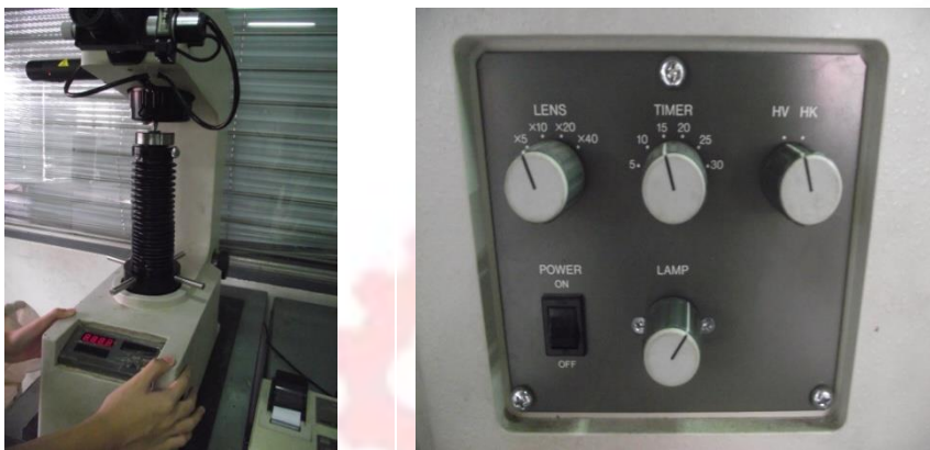
ภาพที่ 12 แสดงการเตรียมเครื่องทดสอบแบบวิกเกอร์ (Vickers)
