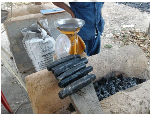
ภาพที่ 7 แสดงเหล็กน้ำพี้ที่ได้จากการขึ้นรูปโดยการตี
