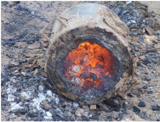
ภาพที่ 5 แสดงการนำเหล็กน้ำพี้ที่ได้จากการถลุงออกจากเตาถลุง
