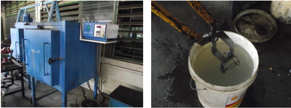
ภาพที่ 14 แสดงการชุบเหล็กน้ำพี้ทั้งแบบดั้งเดิมและแบบถลุงใหม่ด้วยสารจุ่มชุบ ได้แก่ น้ำ
