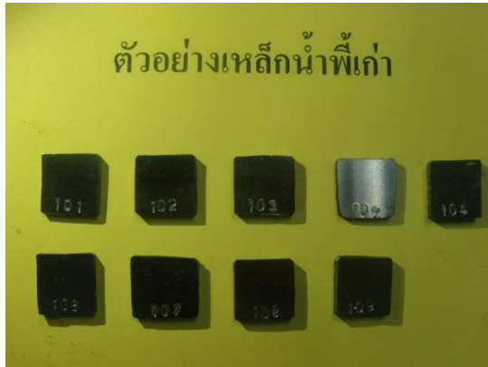
ภาพที่ 10 แสดงชิ้นงานเหล็กน้ำพี้ที่ได้จากเหล็กดั้งเดิม
