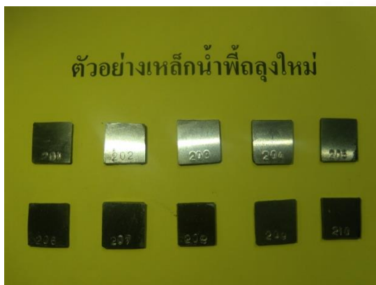
ภาพที่ 11 แสดงชิ้นงานเหล็กน้ำพี้ที่ได้จากการถลุงใหม่
