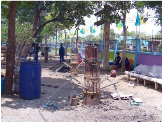
ภาพที่ 2 แสดงการเตรียมเตาก่อนการใส่สินแร่เหล็กน้ำพี้
