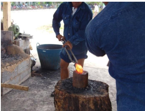
ภาพที่ 6 แสดงการขึ้นรูปเหล็กน้ำพี้จากการถลุง
